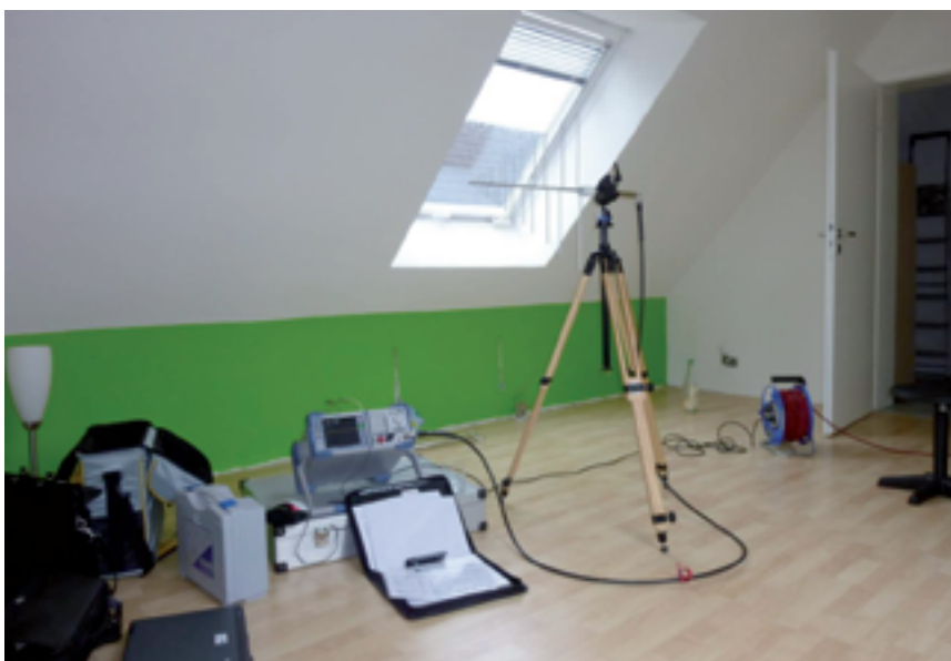
Exemplarischer Messaufbau bei der Sanierungskontrollmessung
